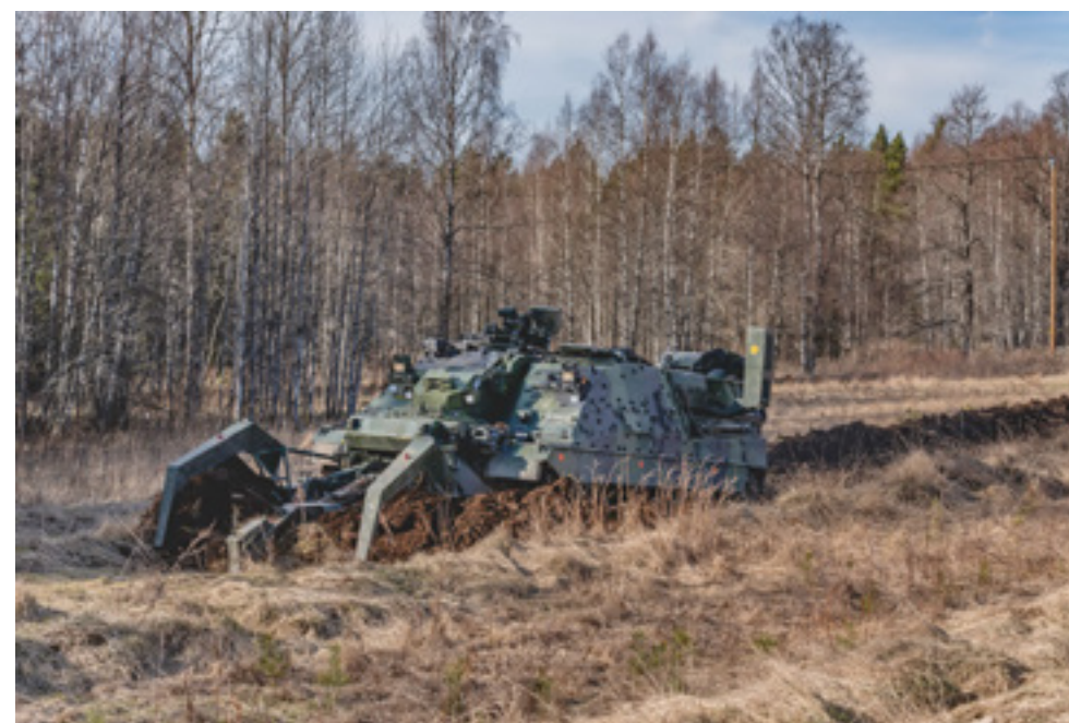
Här använder ingenjörbandvagn 120 minplogen för att skapa väg genom minfält. Foto Försvarsmakten
