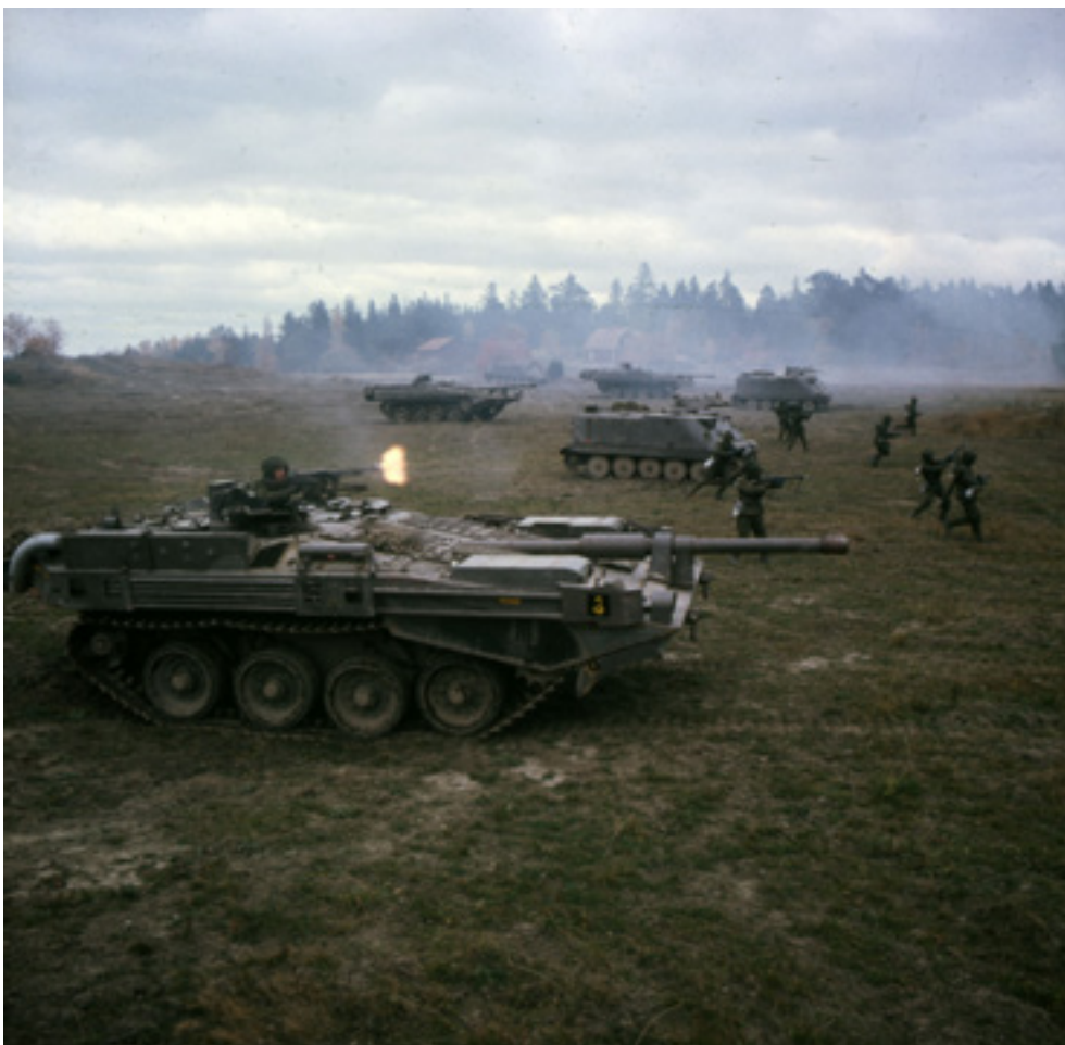
Pansarbataljon 63 under anfall med stridsvagn 103 (S) och pansarbandvagn 302. Stridsvagn S var ett unikt svenskt pansarfordon med låg profil och där den horisontella inriktningen genomfördes genom att vrida hela fordonet. Foto Försvarsmakten, Lasse Sjögren
